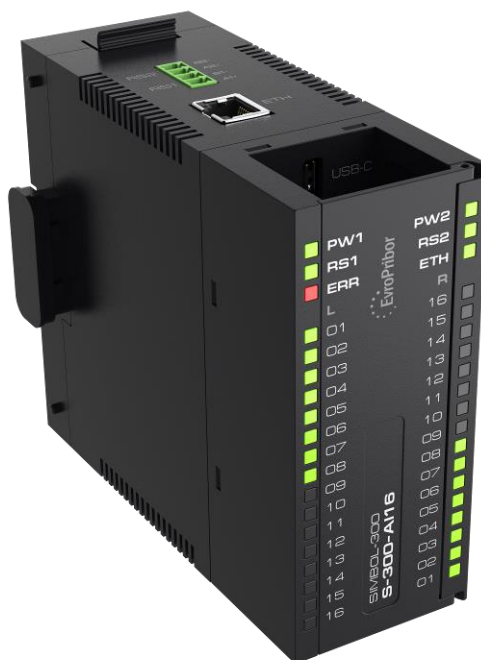
Рисунок 1.1 – Внешний вид модуля контроллера Simbol-300 S-300-AI8
