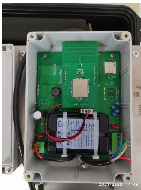
Рисунок 2.5 – Слот для установка SIM-карты в правом верхнем углу
